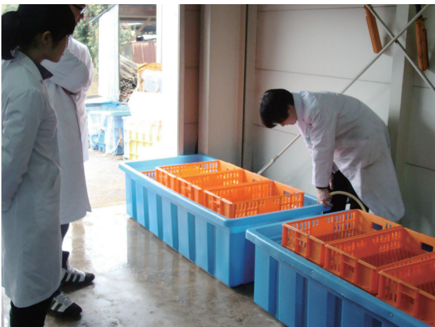
図7 脱塩処理。メッシュコンテナの浮きを防ぐため、最上段の空のコンテナには重しをのせた。
